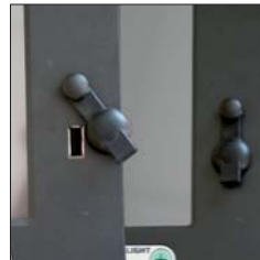
Port USB avec bouchon IP-65 en face avant
